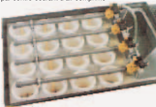
Fig. 17 Dépoussiérage des manches filtrantes par contre-courant d'air comprimé
