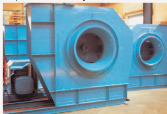
Fig. 8 Exemple de ventilateur centrifuge
