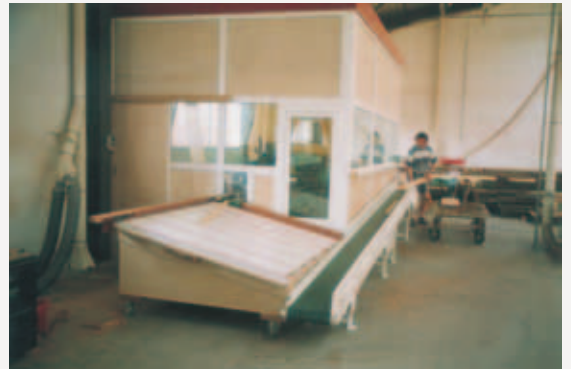
Fig. 18 La moulurière est entièrement encoffrée par une cabine et comporte en sortie un tapis qui ramène les pièces à l'opérateur
